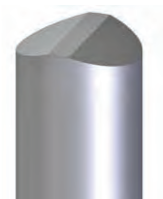
图20: 具有中部小平面的倒角凸模。
