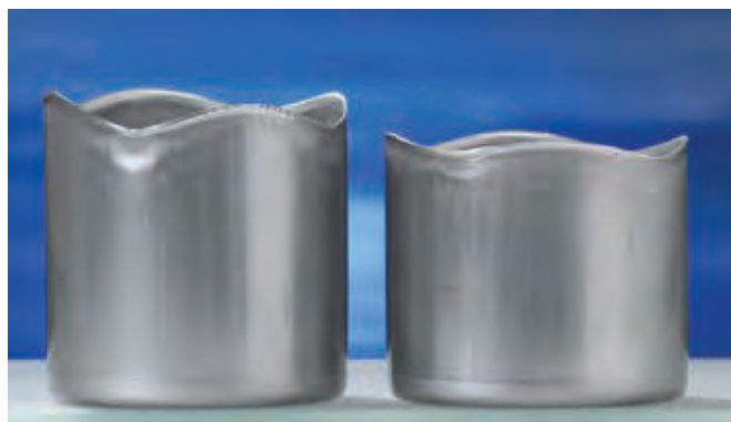
图35: 润滑剂粘度对冲压的影响。使用润滑剂粘度500 cSt(左杯)和40 cSt(右杯)的最大杯形高度。
