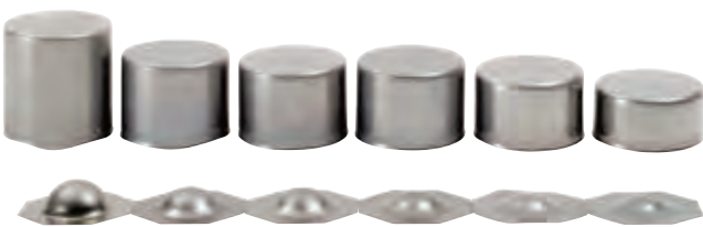
图5：分别为拉深成形和拉延成形的最大拉深杯高度和杯突高度。钢牌号分别为(从左到右)：CR5、Docol 600 DP、Docol 800 DP、Docol 1000 DP、Docol 1200 M 和 Docol 1400 M。
